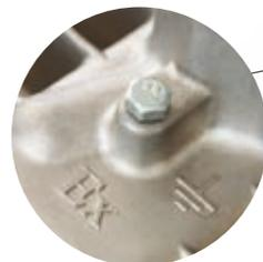
Дополнительное заземление корпуса
